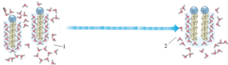
Рис. 9. Зміни структури системи «вода – колоїдна ПАР (МПАР)»: 1 – вільні молекули пар; 2 – димери молекул МПАР
