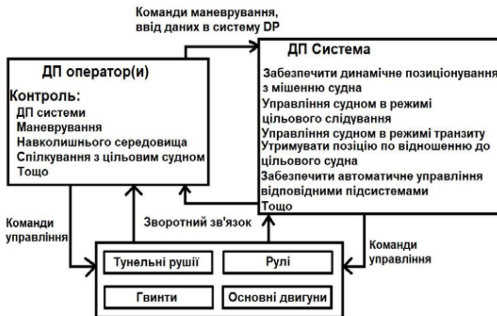
Рис. 1. Структура управління офшорного судна
