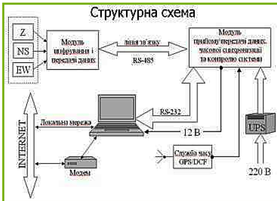
Рис. 8. Структурна схема сейсмічної станції 'DAS-05'. Джерело: власна розробка
