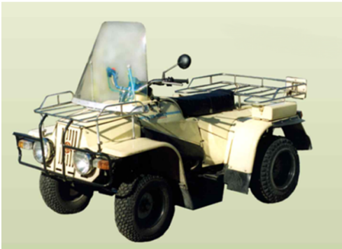
Серійний зразок чотириколісного мотоциклу ЗІМ-800Д з дизелем 2ДТМ (фото ДП «ЗІМ» 1998 року)
