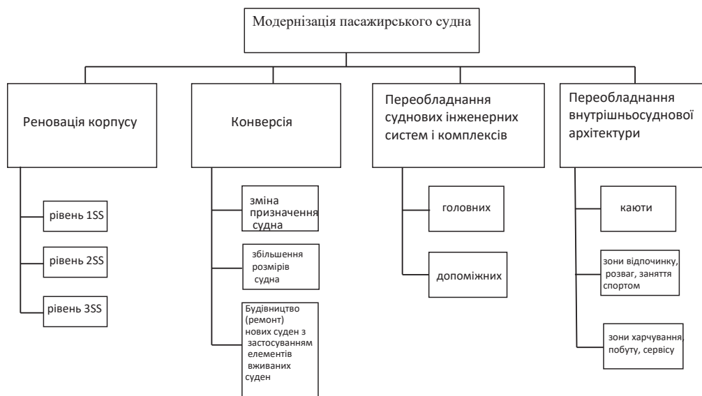
Рис. 1. Структура основних напрямків при проведенні модернізації пасажирського судна
