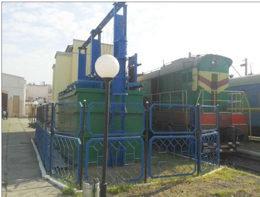
Рис. 1. Индицирование дизеля тепловоза ЧМЭЗ на станции реостатных испытаний в локомотивном депо № 1, Одесса-Сортировочная.
