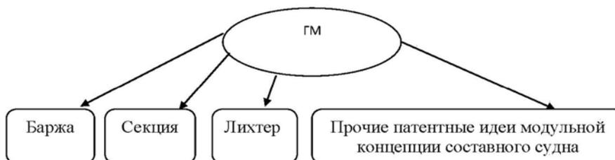
Рис. 3. Типы грузовых модулей составных судов
