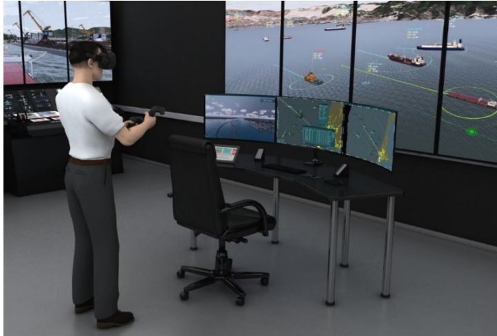
Рис. 6. Приклад відображення елементів надводної обстановки для інформаційної моделі «проста»
