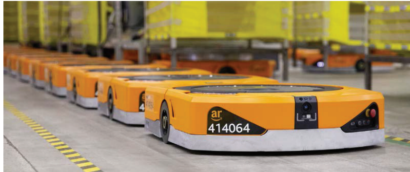
Рис. 4. AGV-системи, які використовуються для оптимізації логістичних процесів
