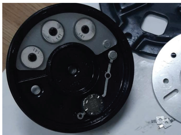
Рис. 6. Розташування трьох малогабаритних ПНЕ перед фільтроелементом у корпусі паливного фільтра кросовера Renault Duster
