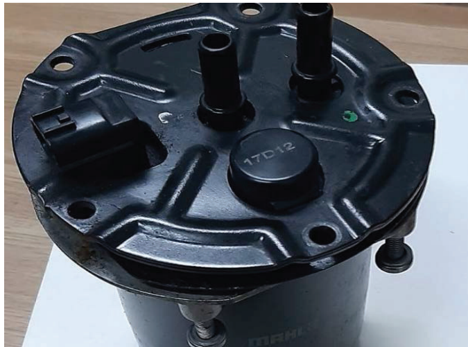
Рис. 5. Фільтр паливний дизеля кросовера Renault Duster 2017 р. виготовлення
