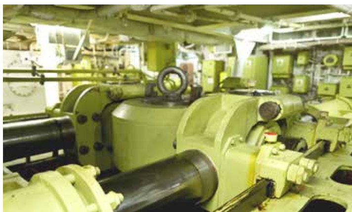
Рис. 1. Загальний вид механізму рульової машини P-18
